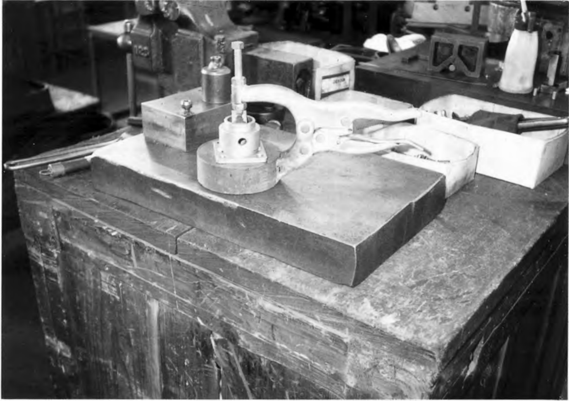
ハンドバイスNO.3 下アゴ溶接加工使用
