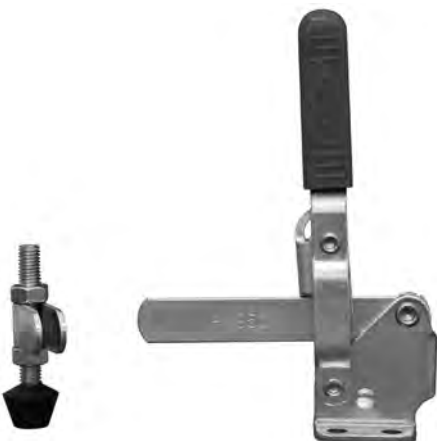
スピンドル (M8×50 P=1.25)ゴム付ボルト付属 全長 68
