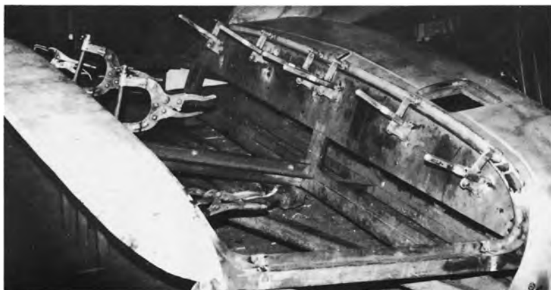
溶接治具にトグルクランプNo.46を使用している例、必要箇所を各々ワンタッチで確実に固定します。
