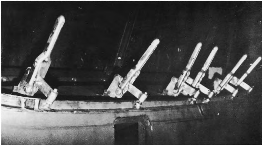
No.44、No.46は最も多く使用されており、特に溶接、仮止め治具に多く使われているクランプです。
