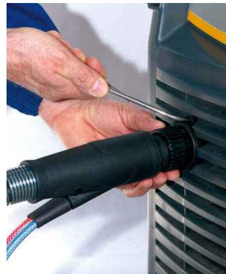
**Sicurezza nell'attacco centralizzato:** la connessione elettrica della torcia avviene solo con l'avvitamento completo della ghiera. Il blocco antirotazione di sicurezza va disattivato con l'utensile specifico fornito da Trafimet.
