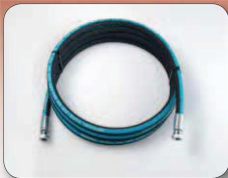
Tubi flessibili in gomma SAE100 R1AT raccordati alta pressione con attacchi femmina diritta filetto BSP, adatti al trasporto di **OLIO** e **GASOLIO** alta pressione.
