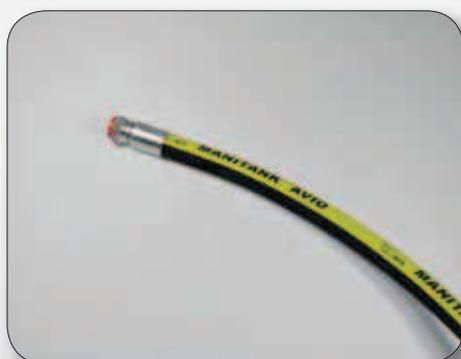
Tubi flessibili in gomma raccordati con attacchi femmina diritta filetto BSP, adatti al trasporto di **CARBURANTI e BENZINE** a bassa pressione **a norme EN 1761:1994**.
