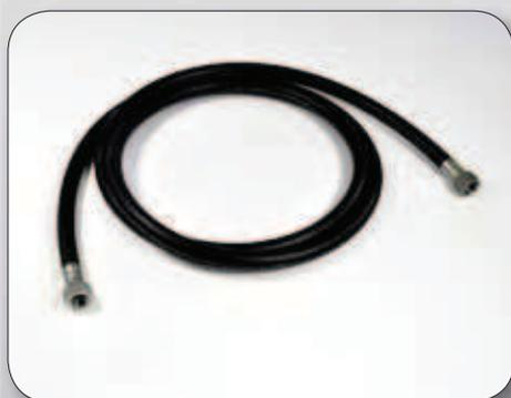
Tubi flessibili in gomma sintetica modello GPH raccordati bassa pressione con attacchi femmina diritta filetto BSP **in acciaio inox**, adatti al trasporto di **UREA (AdBlue®), ACQUA a base e alte temperature, PRODOTTI CHIMICI, ACIDI, GLICOLI, ARIA COMPRESSA**, a bassa pressione.
