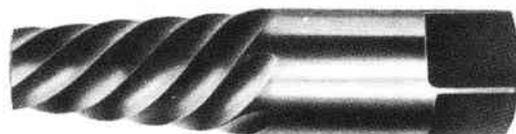
●折れ込みボールド抜き(角型タイプも御座います)
