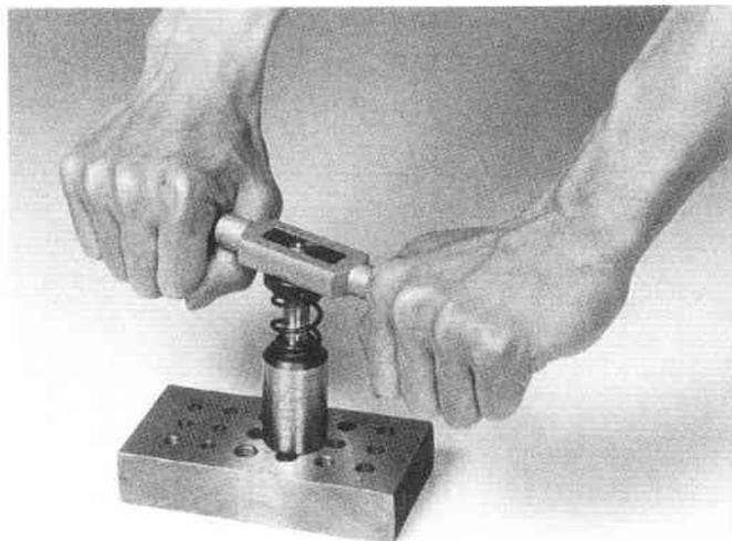
タップを食い付かすために上部から押えるような格好で2～3回転させて下さい。タップは振れがなく食い付いて行きます。その後は普通のタップ立てと同じ要領で結構です。
