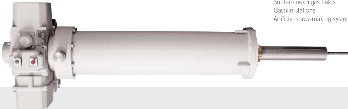
■ Das Arbeitsprinzip basiert auf einem nicht selbsthemmenden Stellantrieb mit einem kupplungsfreiverbundenen vorgespannten Tellerfederpaket als Energiespeicher. Wesentlich ist, dass bei der Wiederherstellung der Spannungsversorgung der Stellantrieb sofort wieder betriebsbereit ist und kein Initialisierungshub oder eine Neueinstellung erforderlich ist.
