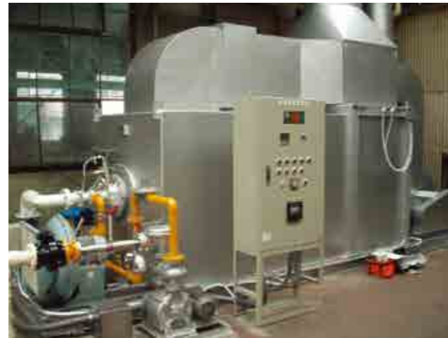
KPD-70 (処理風量70Nm 3 /min) 最大消費量：LPG 58kg/h、13A 65m 3 /h
