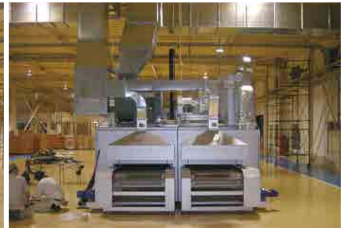
自動車樹脂部品接着材乾燥用 連続コンベア炉
