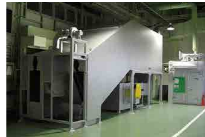
エンジン部品塗装乾燥用 直接熱風・遠赤加熱連続炉
