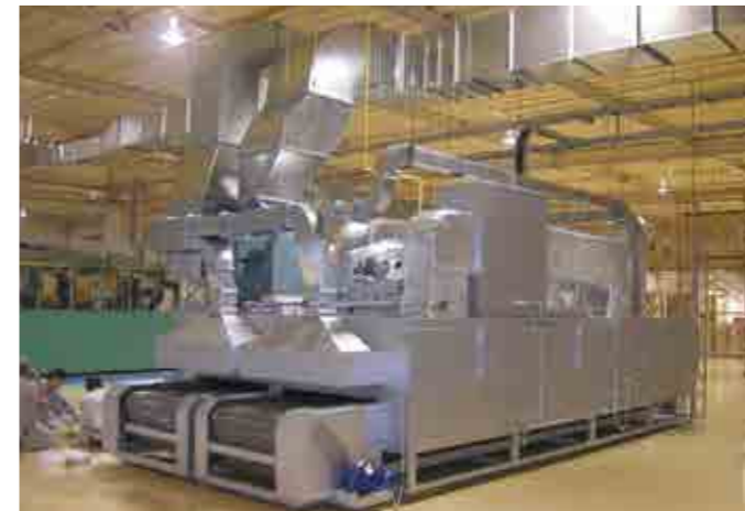
自動車樹脂部品接着材乾燥用 連続コンベア炉
