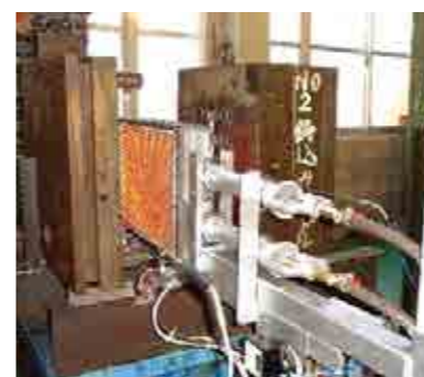
金型予熱用（両面） 最大消費量：LPG 6kg/h
