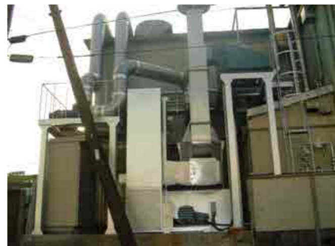
KPDC-140 (処理風量140Nm 3 /min) 最大消費量：LPG 50kg/h、13A 56m 3 /h
