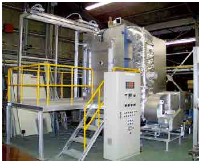
弊社神奈川工場 遠赤外線加熱実験炉 遠赤バーナー BT-33NH×4 基 最大消費量：LPG 9.6kg/h、13A 10.5m³/h
