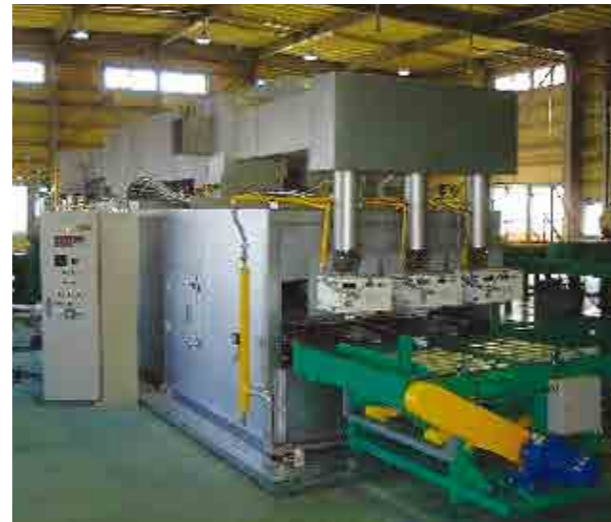
樹脂部品 連続塗装乾燥炉 遠赤バーナー BT-33NH×6 基 最大消費量：LPG 14.4kg/h、13A 15.8m³/h
