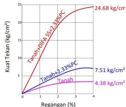
UJI KUAT TEKAN BEBAS PADA UMUR BENDA UJI SATU HARI
